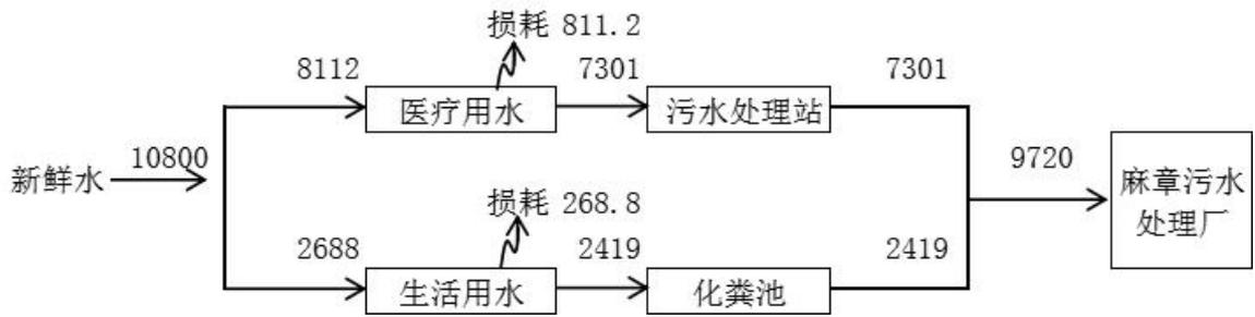
图 2-1 调试期水平衡图 (t/a)
