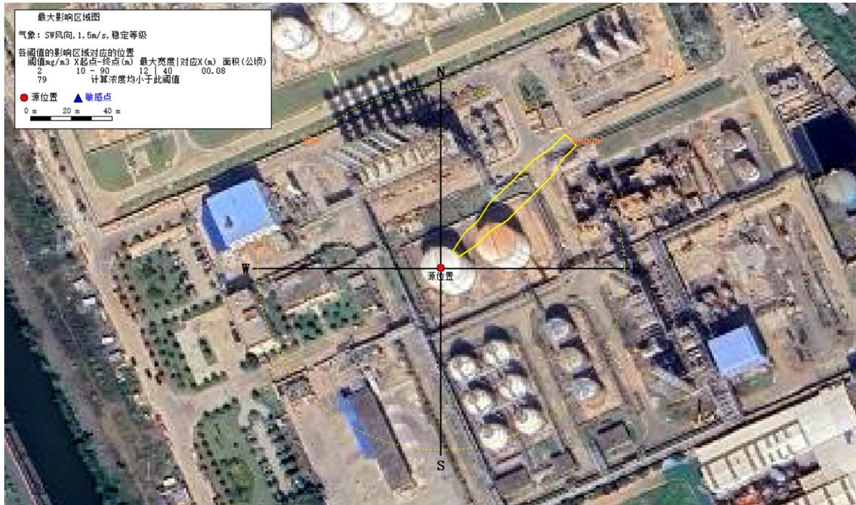
图 7.5.4-14 火灾爆炸伴生/次生 SO<sub>2</sub> 危害区域图（最不利气象条件）
