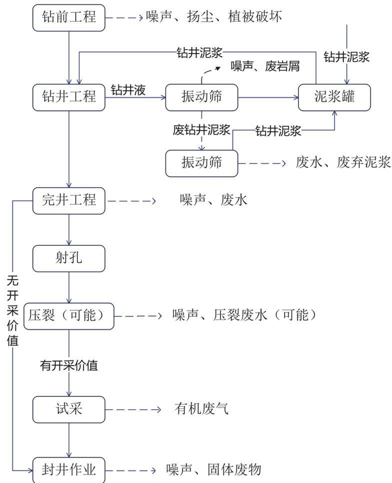
图2-4 施工工艺流程及产污环节图
