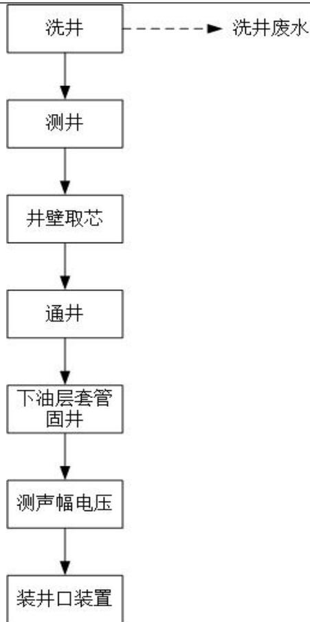
图2-6 完井工程工艺流程图
