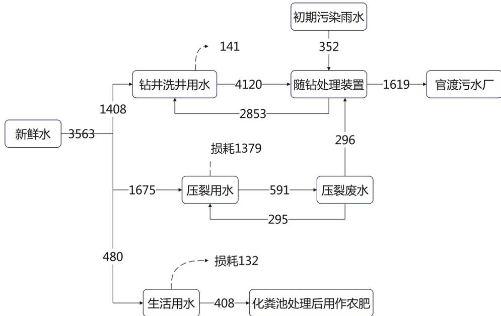
图2-7 本项目水平衡图（单位：t）
