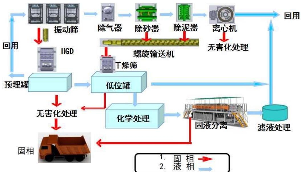
图5-1 随钻处理装置工艺流程图
