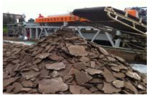
图5-3 压滤后泥饼图例
