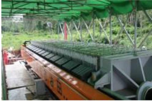
图5-2 固液分离设备图例
